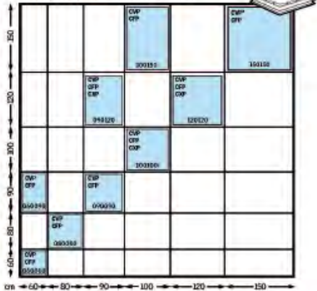
Finestra cupolino (dimensioni del foro nel solaio)
